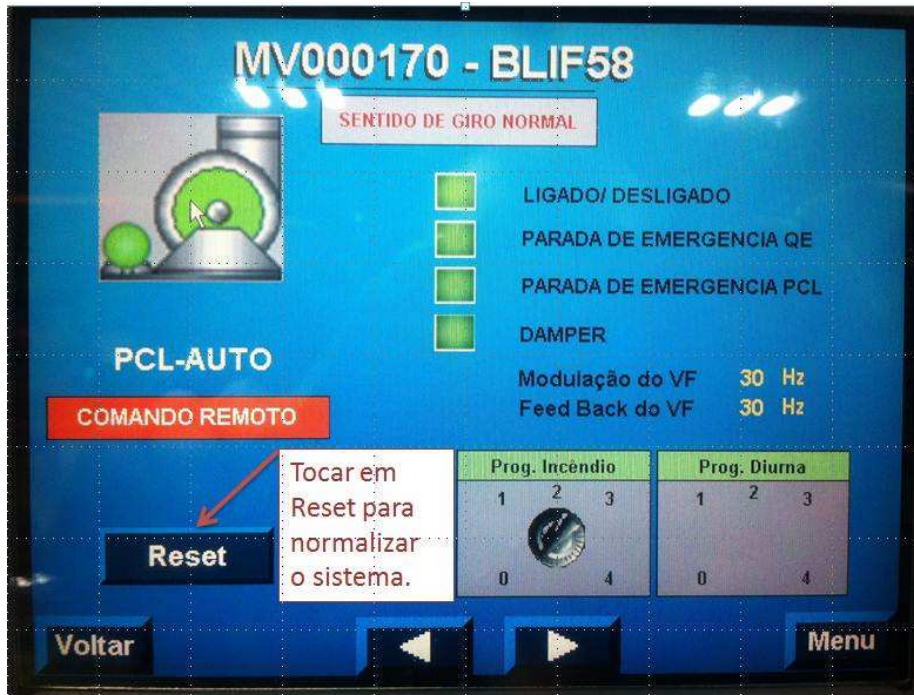
Figura 11 - Tela do IHM (visualização do status do equipamento)
