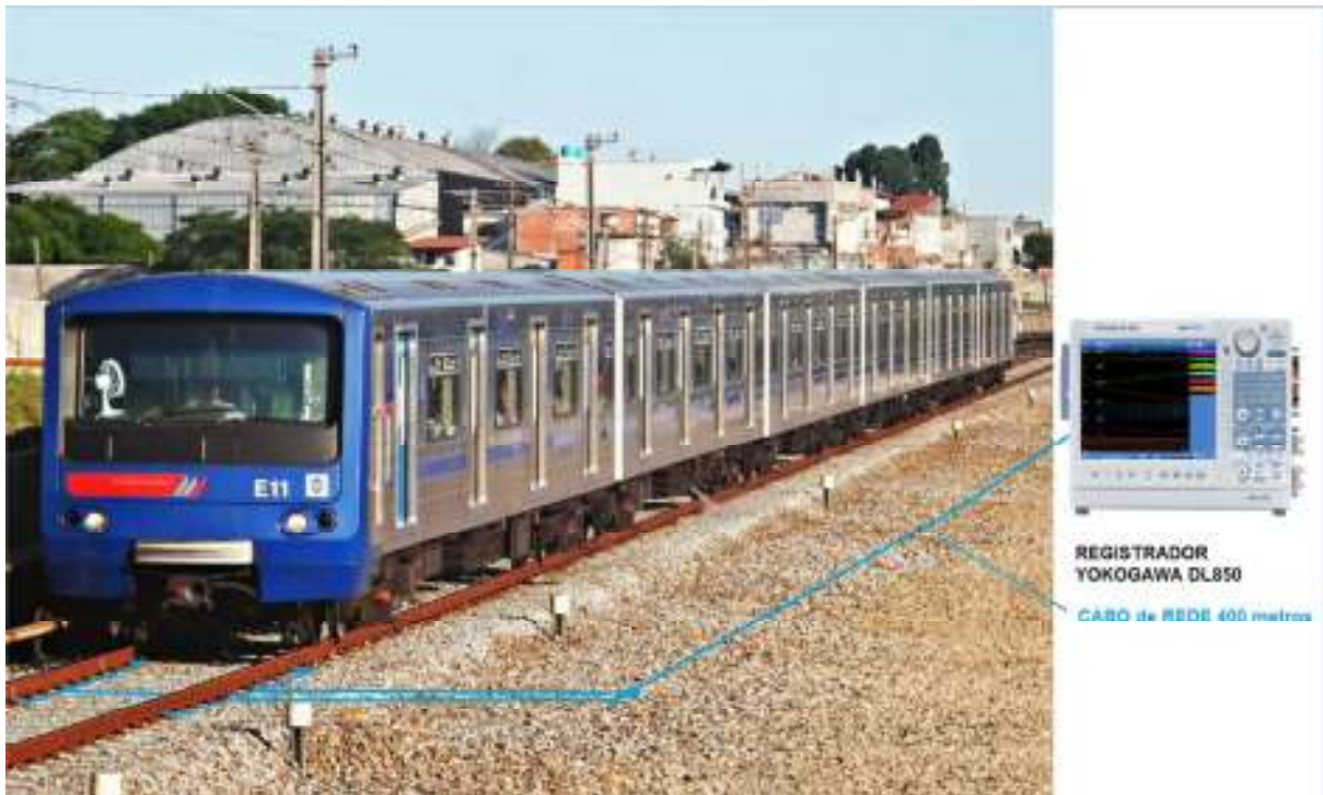
Figura 4 – Ilustração das ligações para medição e Registro da Assinatura de Corrente que pode ser monitorada à uma distância de 400 metros.
