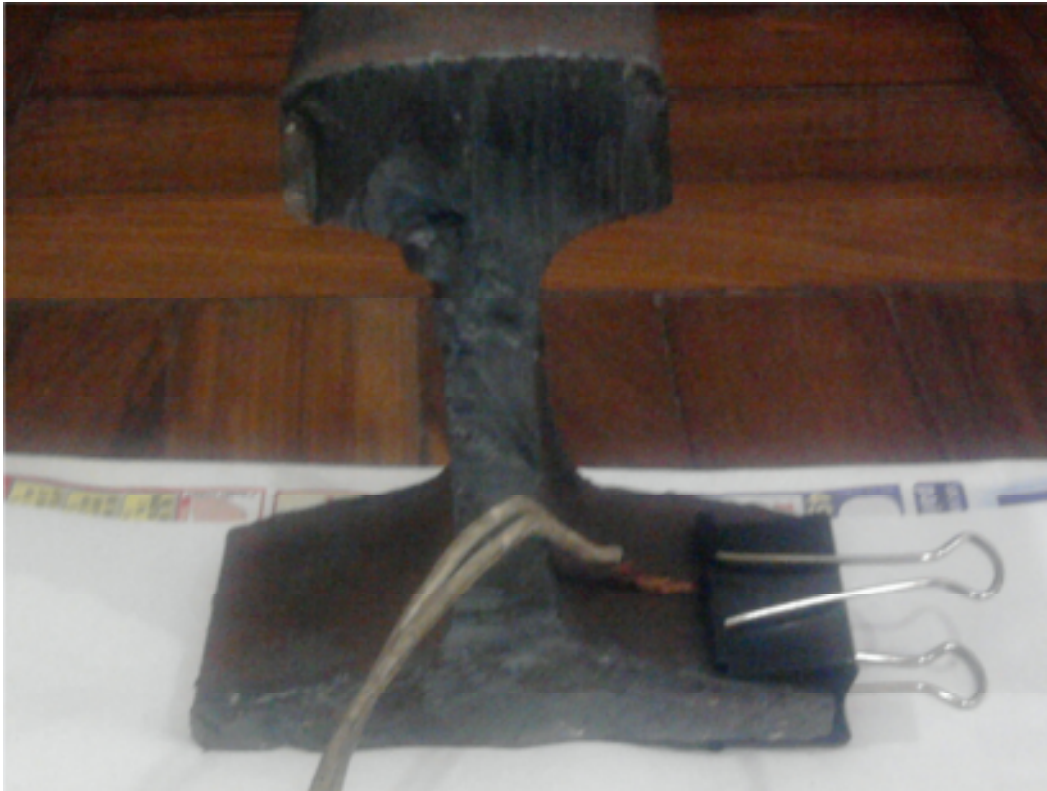
Figura 15 – Detalhe do estudo da conexão realizada com clips.
