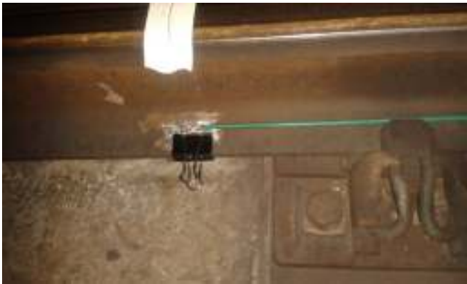
Figura 17 – Detalhe da fixação do cabo de medição ao trilho utilizando o Clips.
