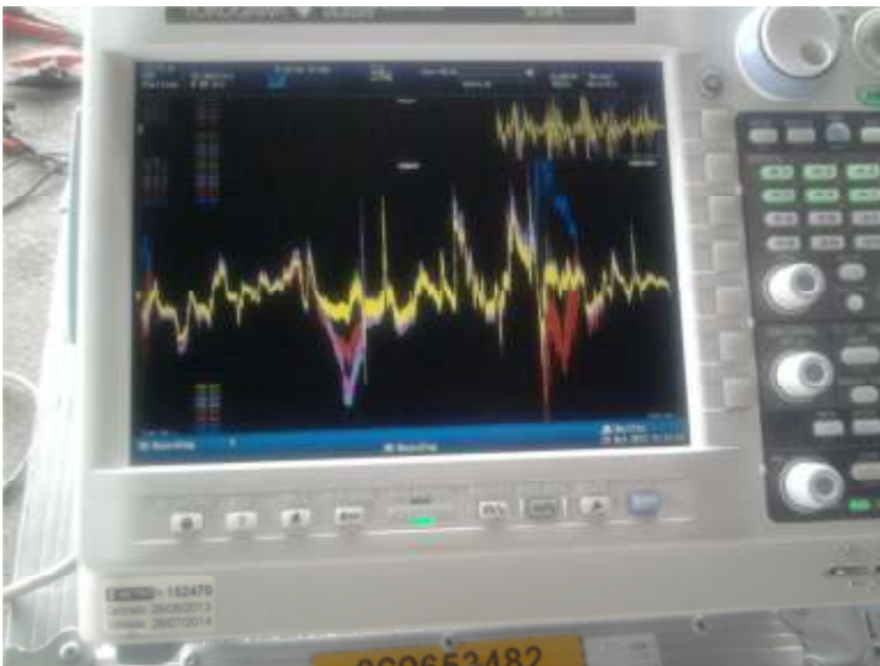
Figura 21 – Nesta imagem mostra a capacidade de monitorar 08 pontos ao mesmo tempo (cada cor representa a corrente em cada trilho monitorado).
