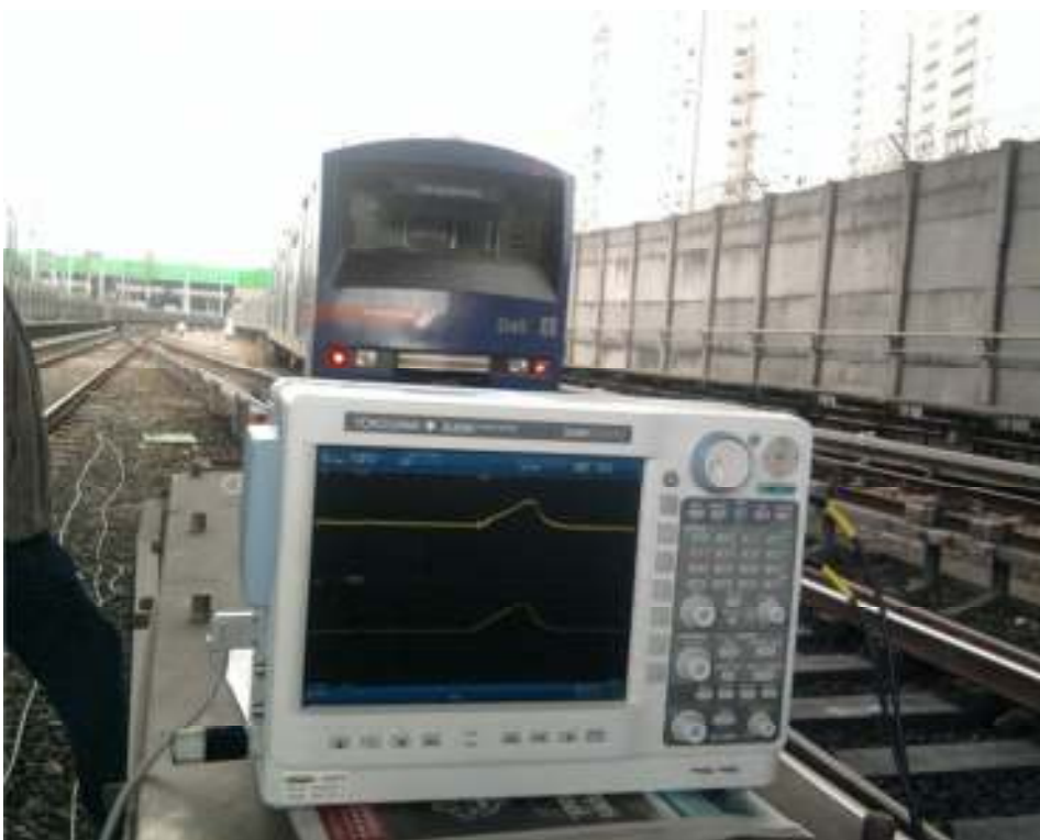
Figura 8 – Avaliação dos níveis de sinal e ruído com 08 metros de espaçamento das conexões nos trilhos.
