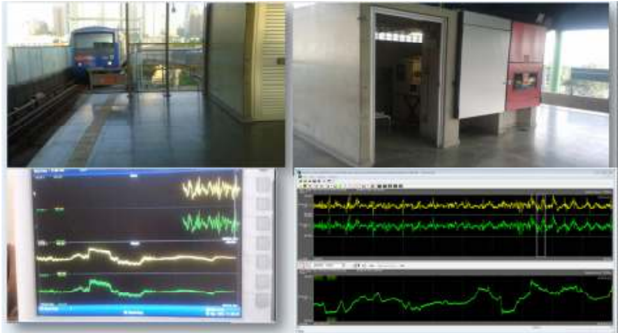
Figura 23 – Exemplo de aplicação da tecnologia de medição da assinatura de corrente de propulsão, código de velocidade e ocupação na estação Imigrantes - Linha 2 -Verde.
