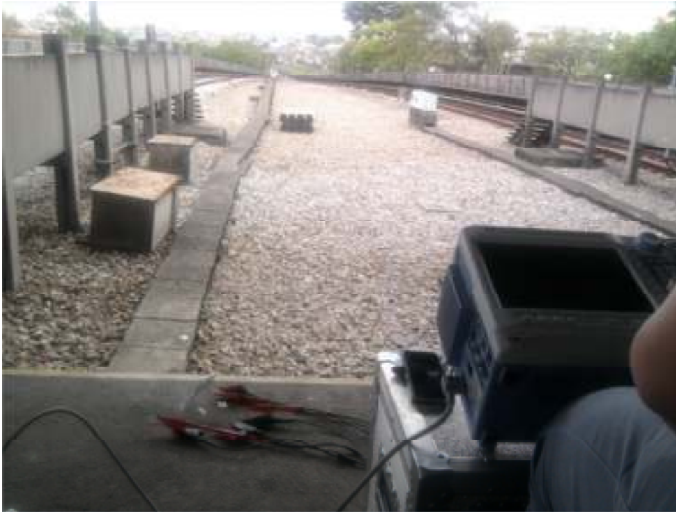
Figura 20 – Foto ressaltando a distância (400 metros) do ponto de aquisição a do instrumento ( o ponto de aquisição esta na regioo onde o trem começa a aparecer na imagem acima).
