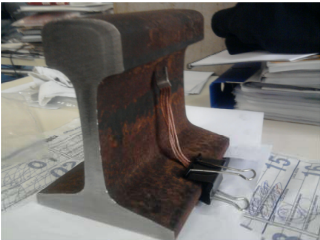
Figura 14 – Detalhe do estudo da conexão realizada com clips (tipo Grampomol).
