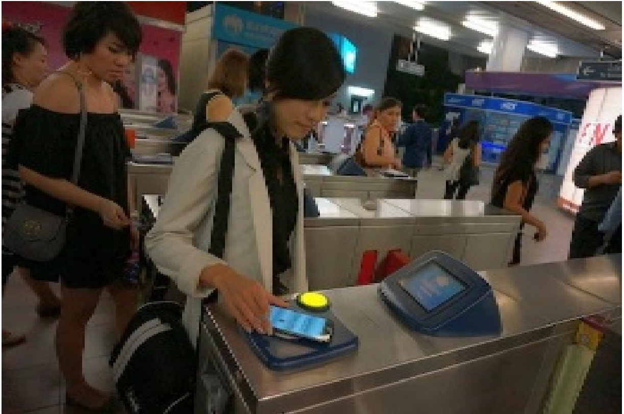
Figura 1 – Entrada de passageira no Metrô, na Tailândia, usando bilhetagem NFC - AISmpay (Fonte: http://mobiledista.com/archives/63671 )
