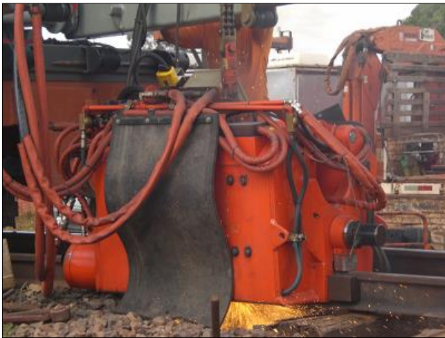
Figura 3 - Cabeçote de soldagem elétrica (Thiago Viana, 2011)
