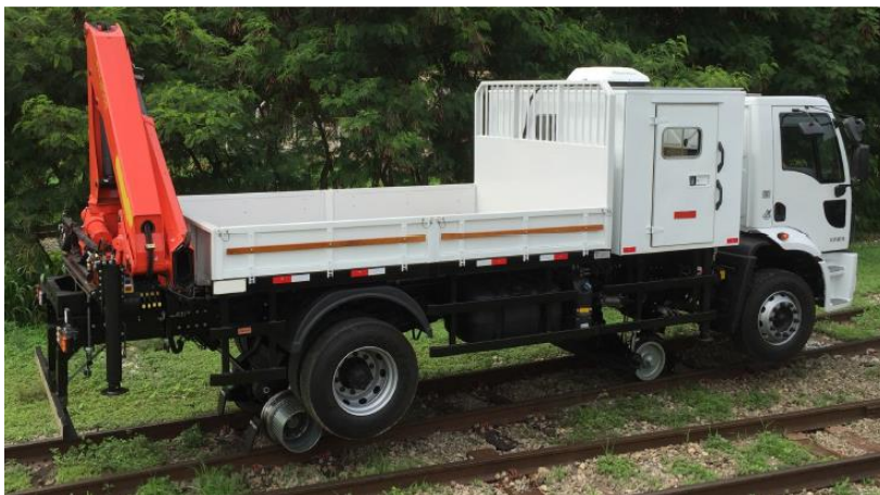
Figura 14- Caminhão carroceria munck cabinado rodoferroviário (especificação fornecedor)
