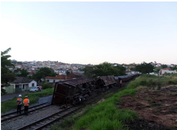
Tombamento – causa: linha desnivelada em junta
