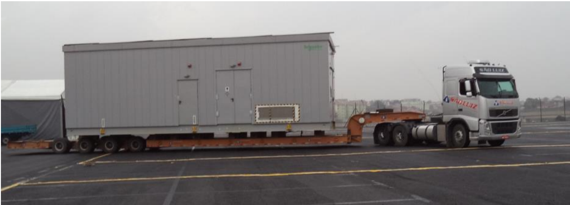
SUBESTAÇÃO RETIFICADORA “FLEX” E TEMPORÁRIA
