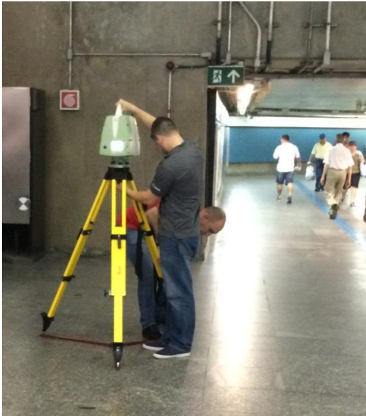
Figura 7 - Execução de escaneamento na estação Ana Rosa (Soledade, 2016)
