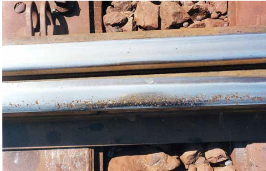
Figura 14 – Fadiga concentrada na bitola do AMV
