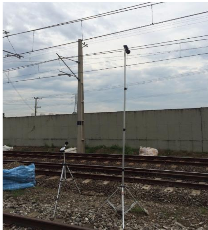
Figura 9: Medições para caracterização do trem CAF 7000.
