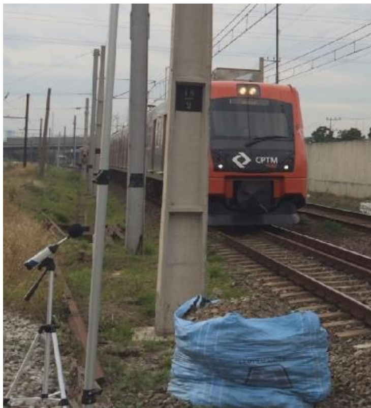
Figura 9: Medições para caracterização do trem CAF 7000.
