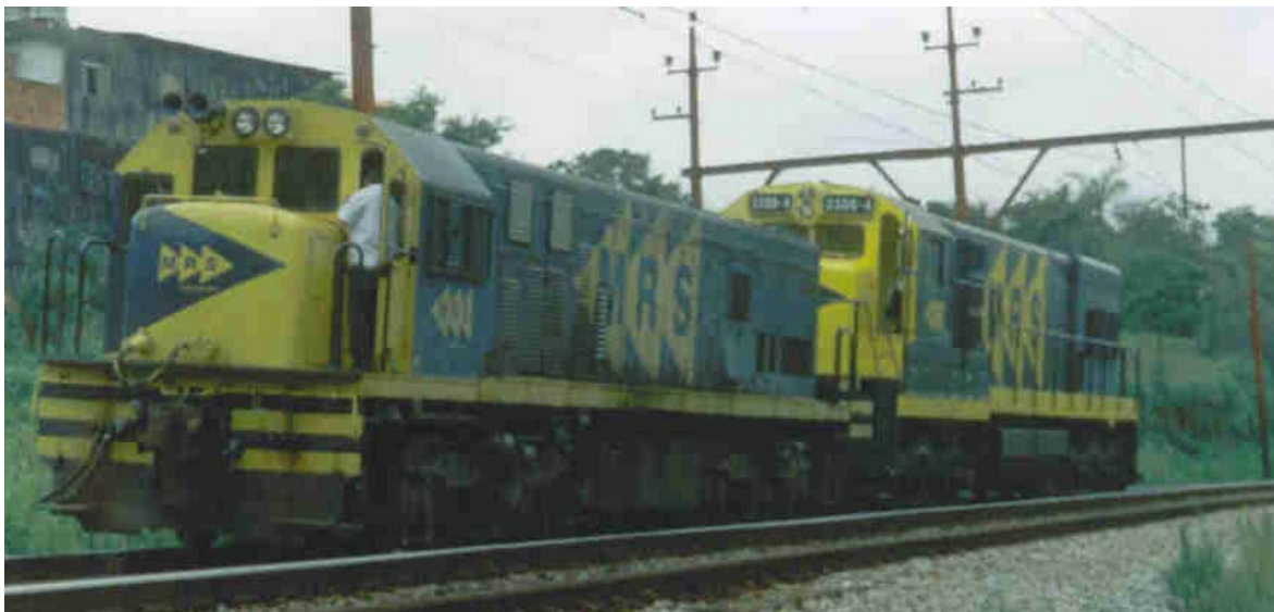
Foto 1- Locomotivas U20C (em primeiro plano) e a U23C utilizada para determinação das deflexões na via.
