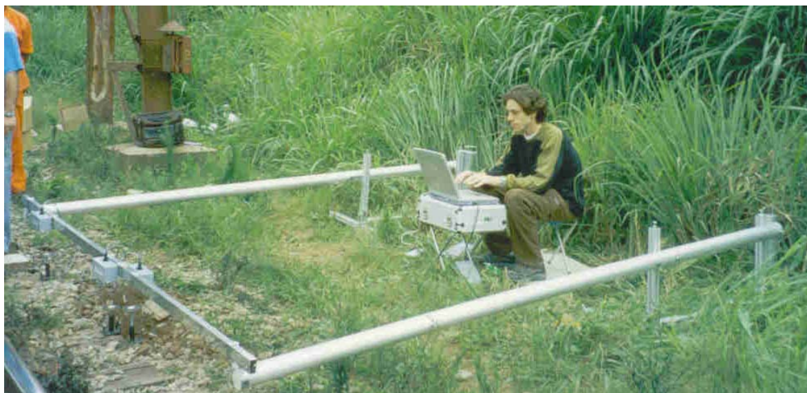
Foto 2. Equipamento de medição das deformações recuperáveis, constituído por 3 equipamentos lasers, instalados sobre viga de suporte (paralela à via), e por notebook (ao centro) para registro dos dados.
