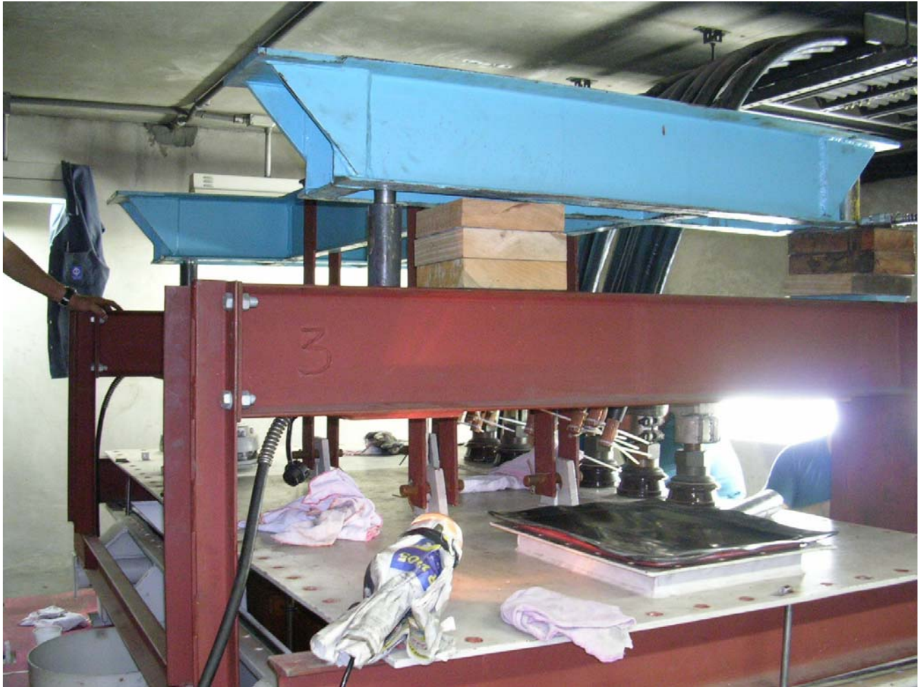
Fig. 01 – Dispositivo para içamento da parte ativa do transformador
