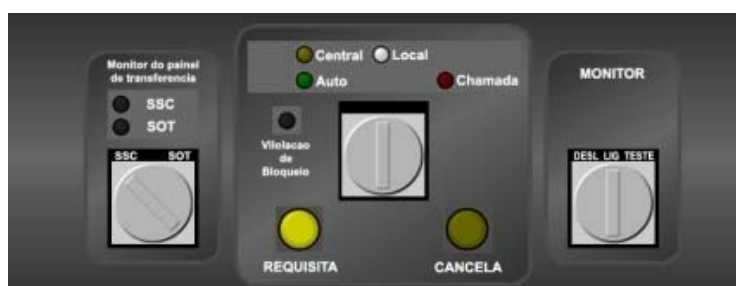
Painel de controle : Seleciona e indica qual o modo de controle do trecho gerenciado pelo Interlocking
