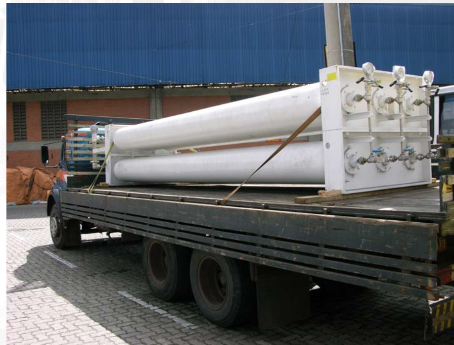
TANQUES DE ARMAZENAGEM DE HIDROGÊNIO
