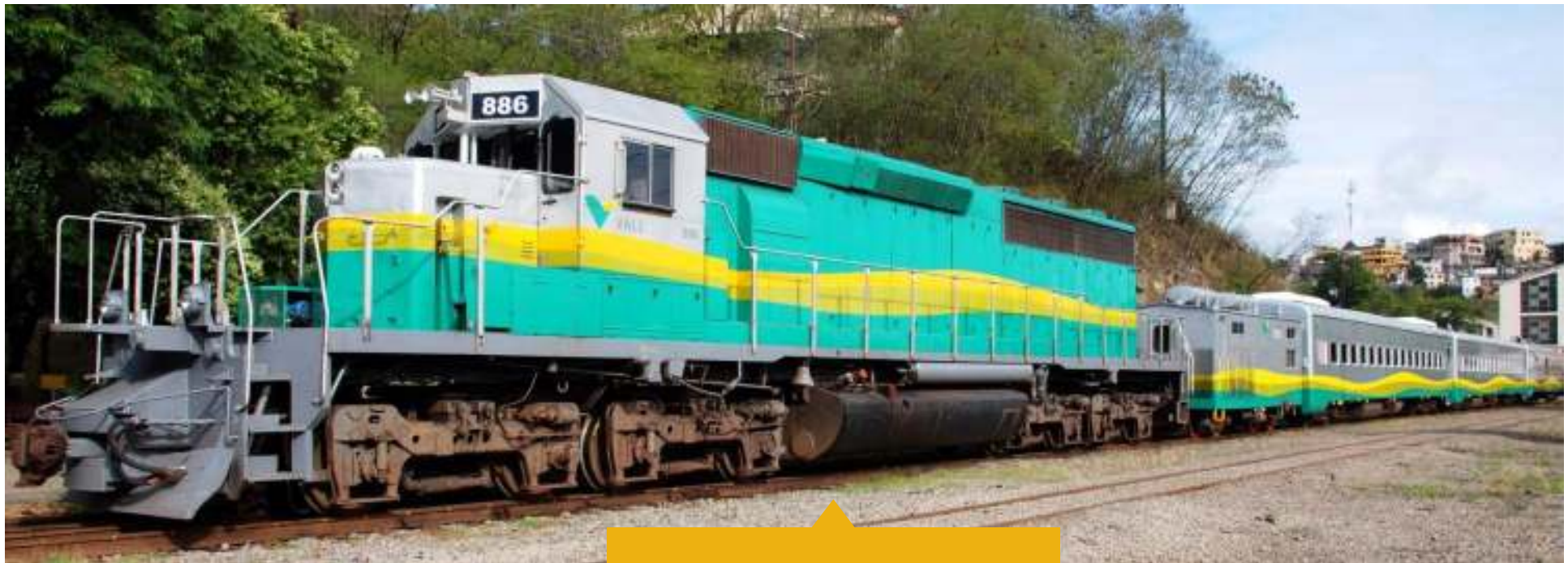
Locomotiva Diesel Elétrica Modelo SD-45
