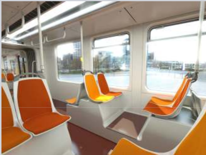
Configuração de assentos sobre a área dos truques com 16 lugares
