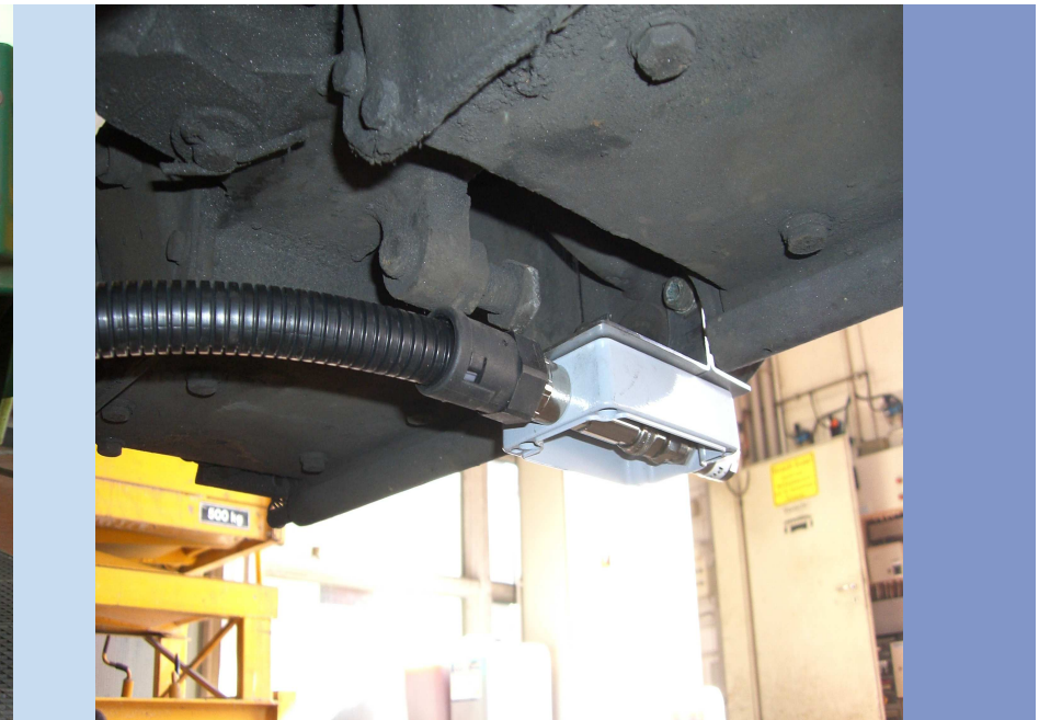
Vista inferior do contato montado na cabeça de engate
