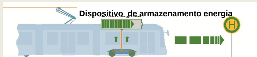
Armazenamento de energia durante a frenagem
