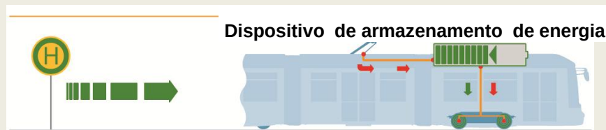
Utilização de energia armazenada durante a aceleração
