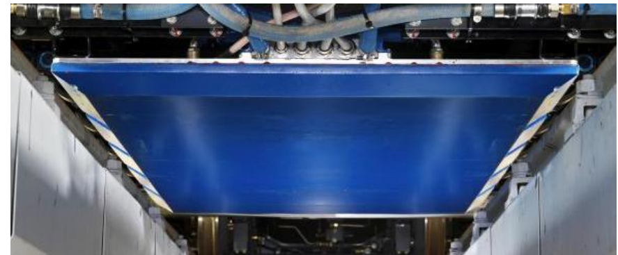
Receptor de energia embaixo do veículo
