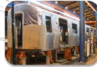
NY Metro - caixas
