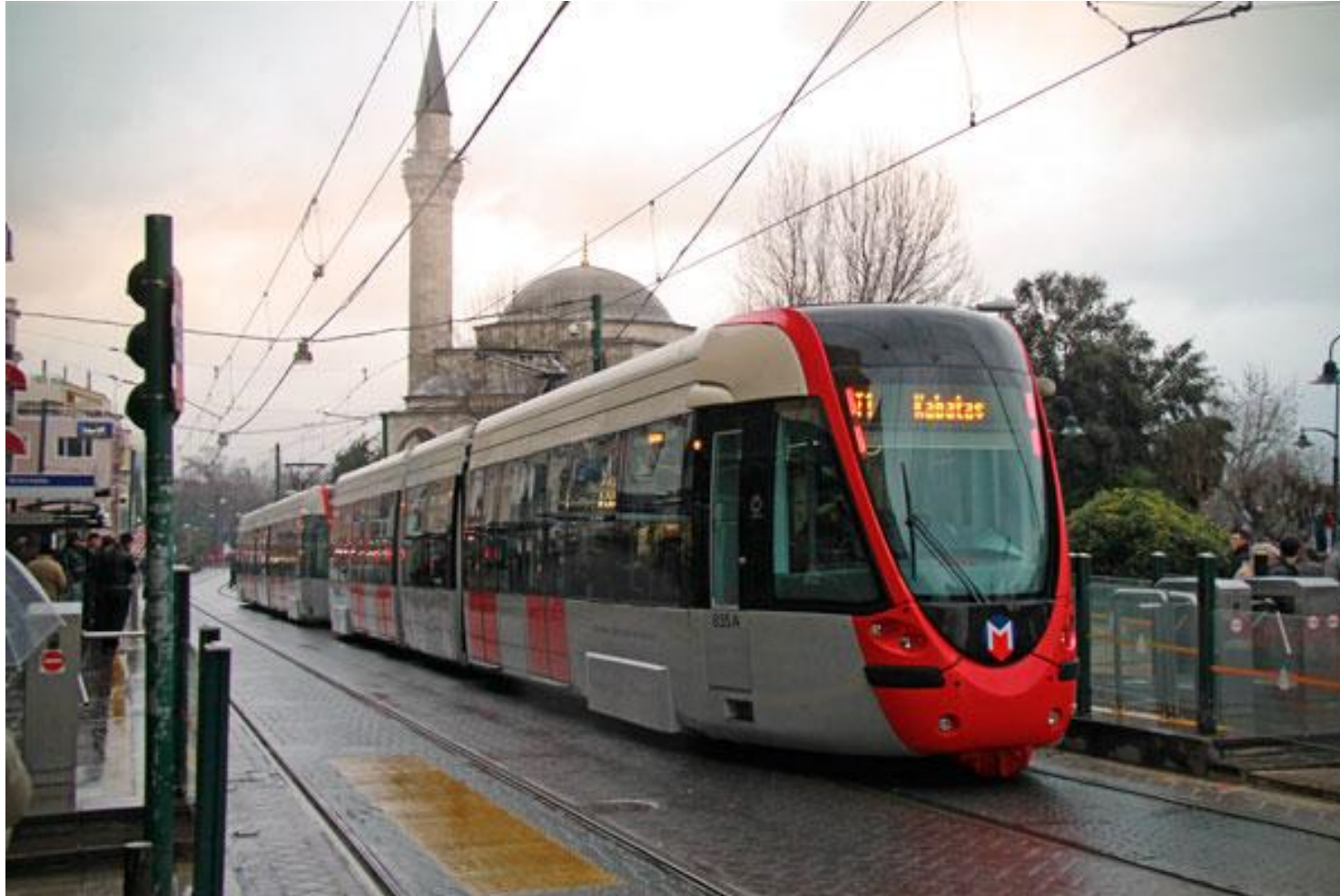
VLT de Istanbul - Unidades duplas de 30 m com capacidade para mais de 600 passageiros / composição
