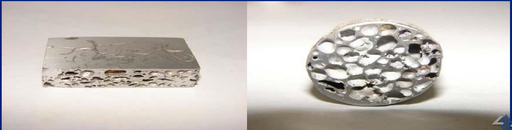
Figura 3: Amostra de um corpo de prova de espuma de alumínio obtida no LdTM – Laboratório de Transformação Mecânica - UFRGS.
