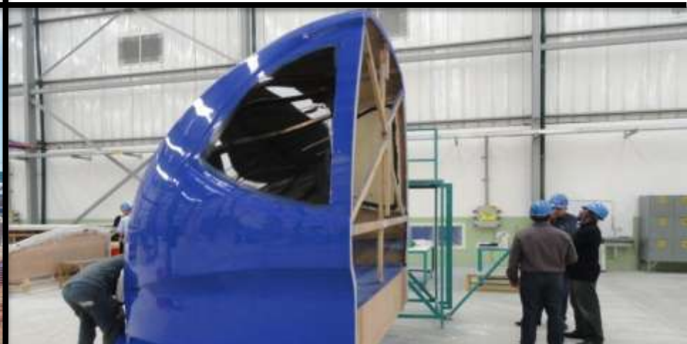
Construção dos moldes do veículo
