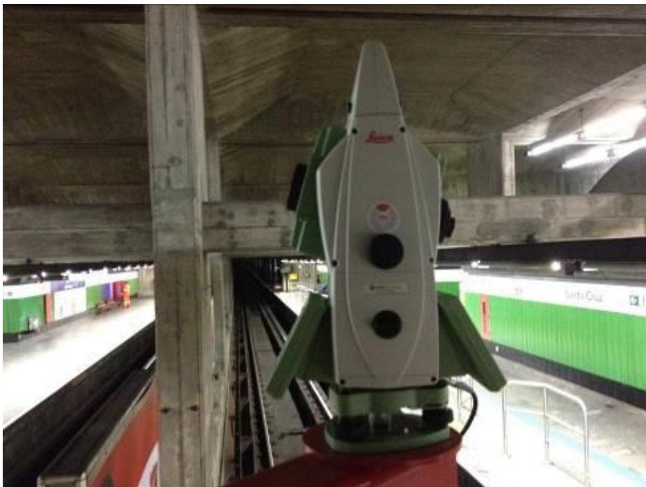
Figura 4: Estação total robótica
