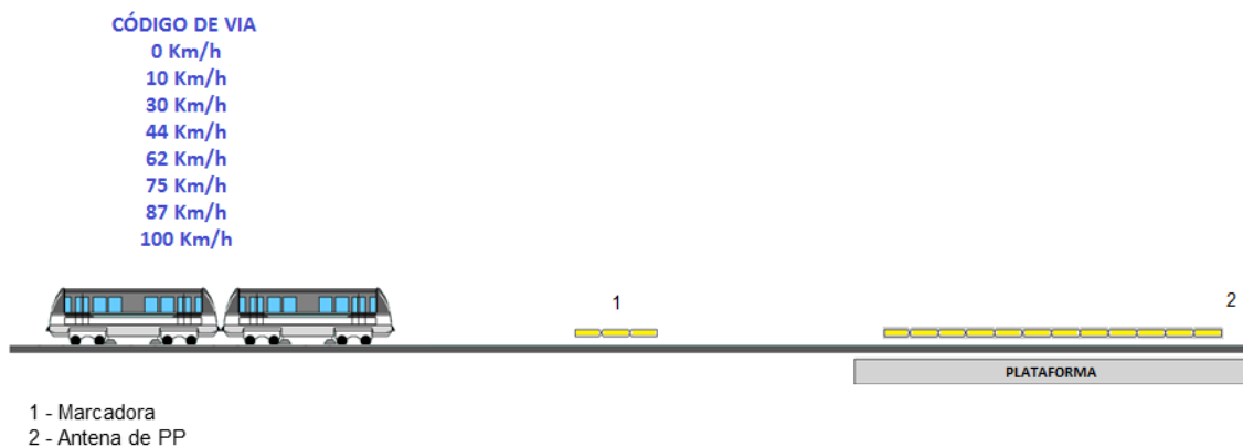
Figura 3: Velocidade imposta pelo código de velocidade de via – antes da antena marcadora
