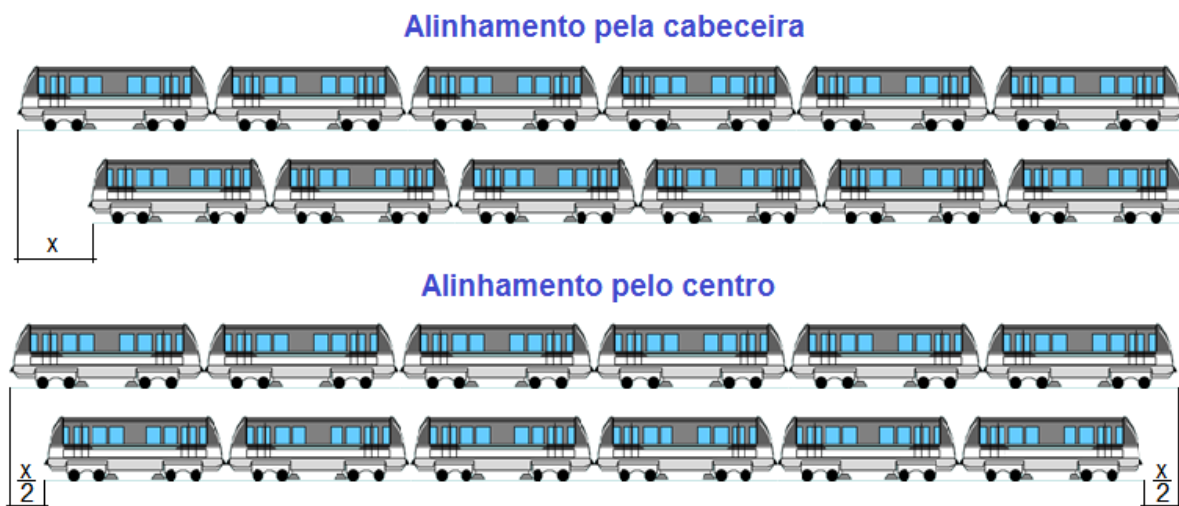
Figura 6: Diferença de comprimento das diferentes frotas e estratégia de alinhamento na plataforma
