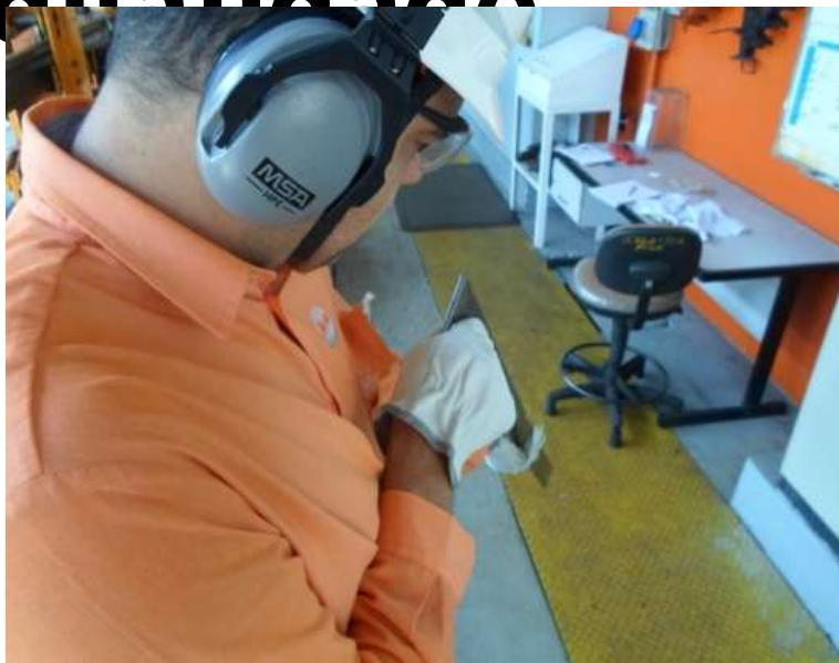
Régua para verificação de empeno na região soldada
