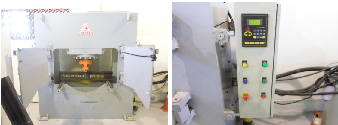
Figura 3: Teste de flexão da EFVM.
