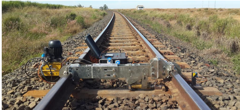
Figura 18 – Equipamento para Realização do Single Tie Push Test
