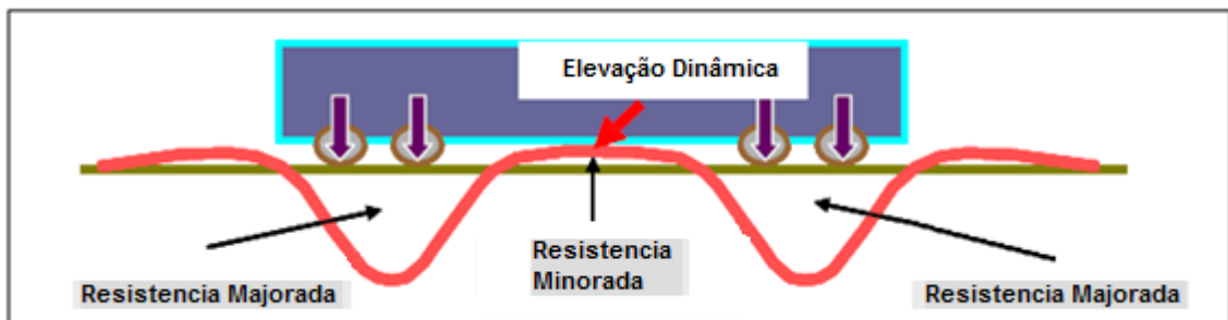
Figura 3 - Ilustração Dinâmica Trem - Via
