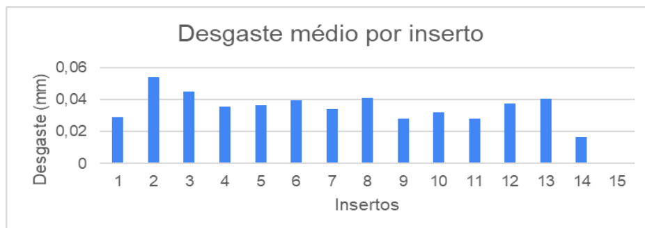
Figure 2: Desgaste médio em todos os passes por inserto
