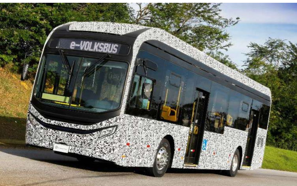
Desenvolvido pela equipe de engenharia brasileira, especialmente para o mercado nacional, o chassi elétrico da VWCO tem autonomia de 350 quilômetros e 12 packs de bateria
