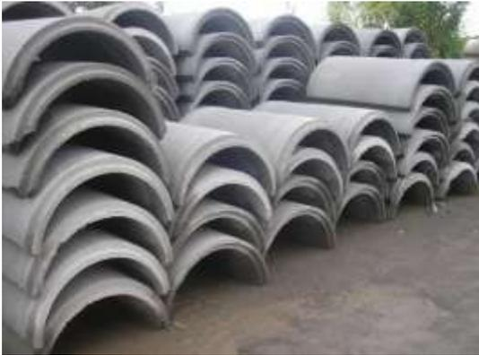
**Figura 3 - Canaletas tipo meia-cana 600 mm posicionadas em canteiro.**
