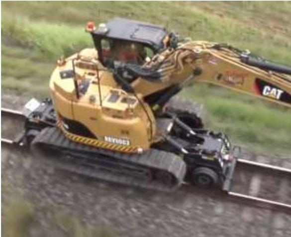
**Figura 24 - Sistema Rodoferroviário acoplado em escavadeira hidraulica**
