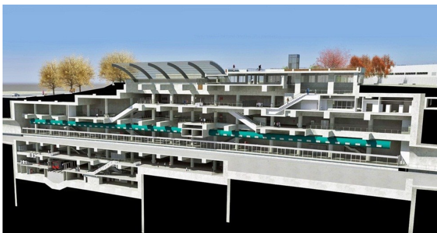
Figura 2 - Corte esquemático do Projeto Básico licitado da Estação Anália Franco – método construtivo: Vala a céu aberto (VCA)
