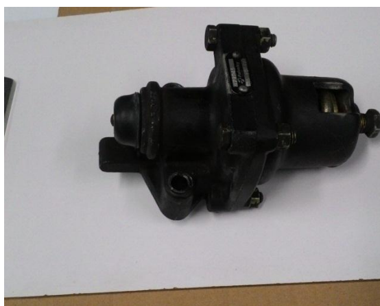
Figura 9 - Válvula de regulação de portas N1
