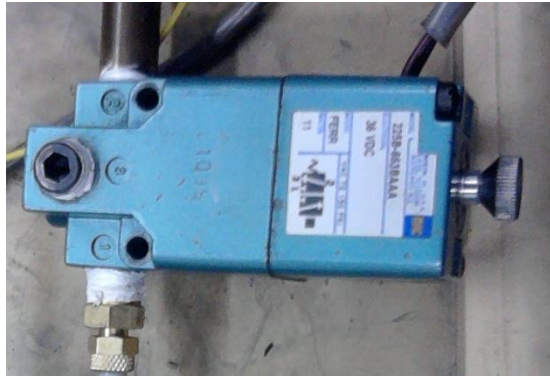
Figura 10 - eletroválvulas 36V, 3 vias 2 posições
