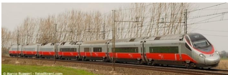
Figura 1 – Trem pendular ativo ETR 600 da Alstom. Fonte: leferrovie.it (2014)
