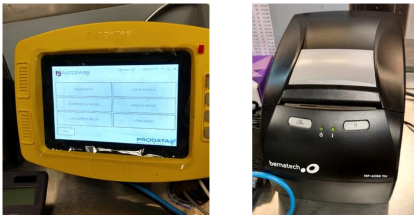
Figura 19 - Equipamento touch screen DC 1000 e impressora térmica.
