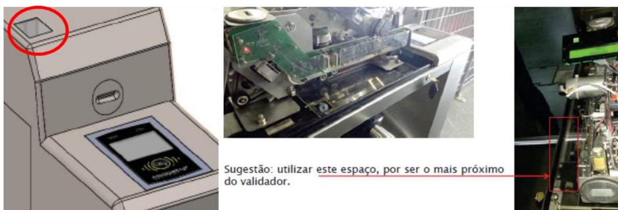
Figura 14 - Solução de instalação do validador (scanner) de QR Code na Estação Autódromo.
