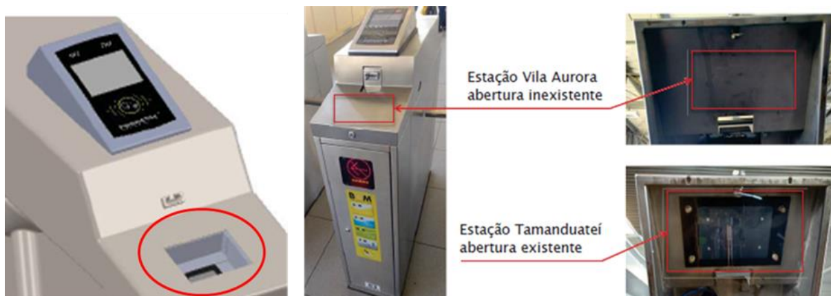
Figura 12 - Solução de instalação do validador de QR Code nas Estações Vila Aurora e Tamanduateí.
