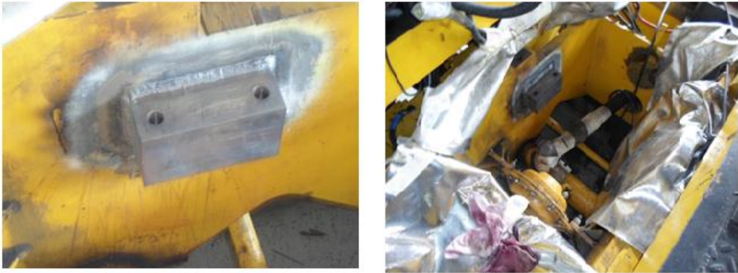
Figura 6 – Alteração no suporte de fixação da transmissão
