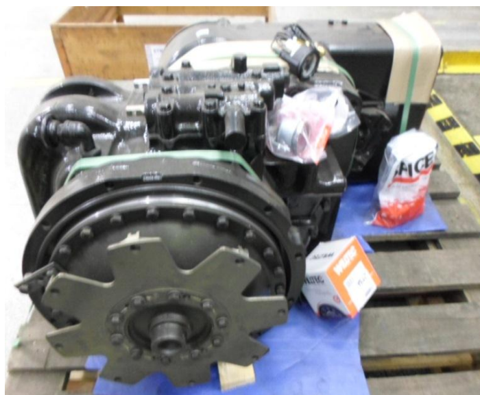
Figura 5 – Nova transmissão de comando mecânico nacional
