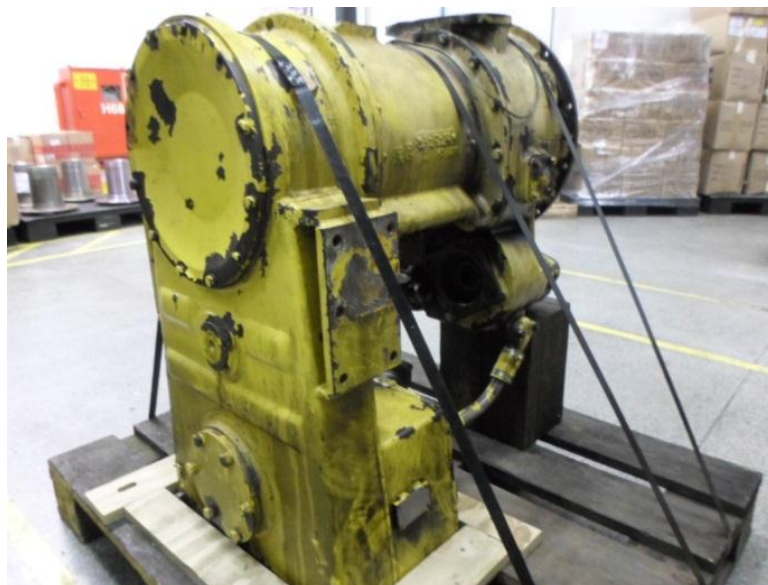
Figura 3 – Caixa de transmissão de comando mecânico original
