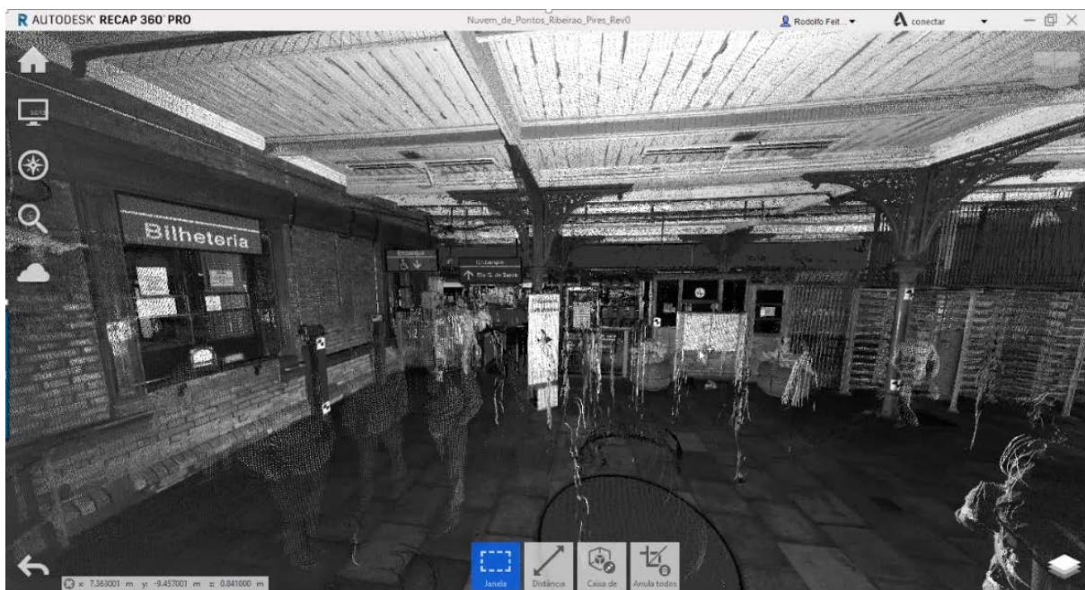
Figura 3 – Levantamento por Laser Scanning - Estação Ribeirão Pires - visualização através do software Autodesk Recap 360 PRO
