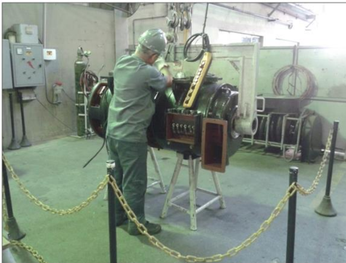
Ambiente aberto - Risco de projeção de objetos durante execução dos testes
