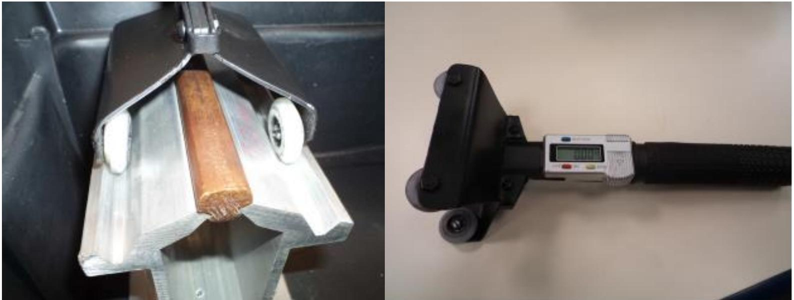
**Medidor de Desgaste de Rede Aérea Rígida**
