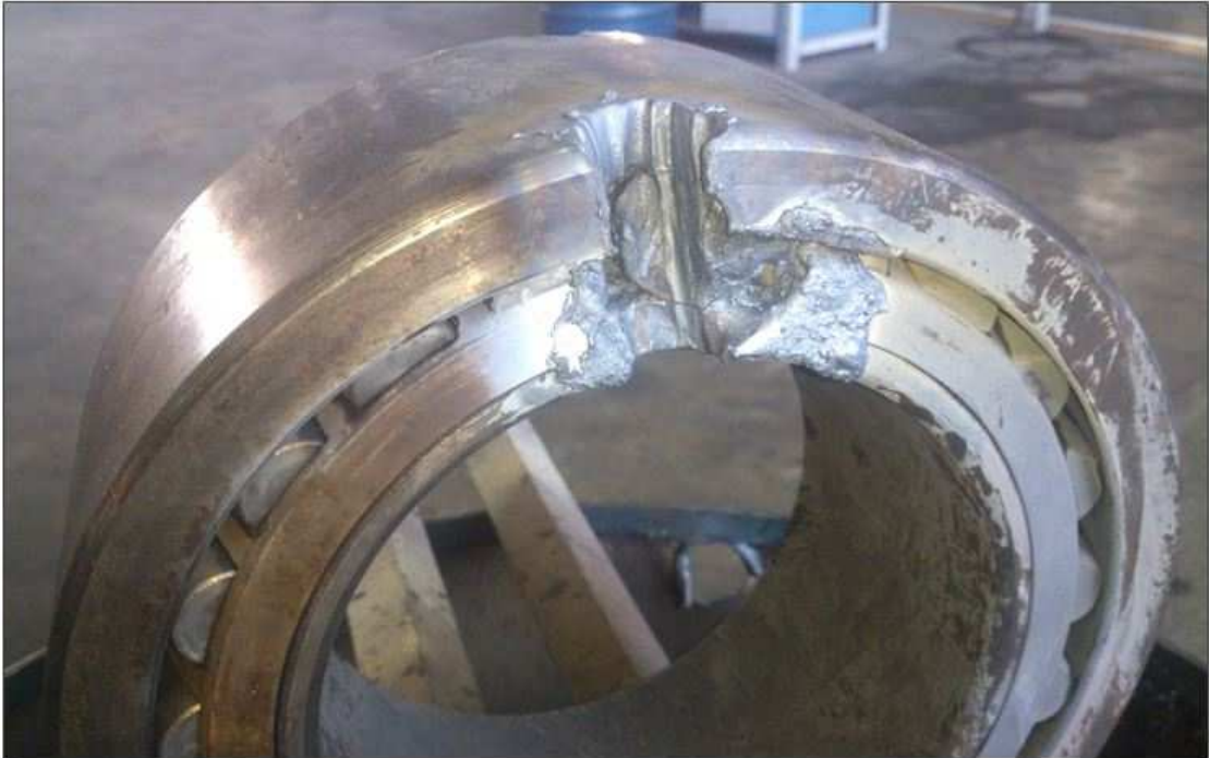
Rolamento inutilizado pelo processo de corte oxi-acetileno Alto Riscos ao Meio Ambiente e aos Empregados
