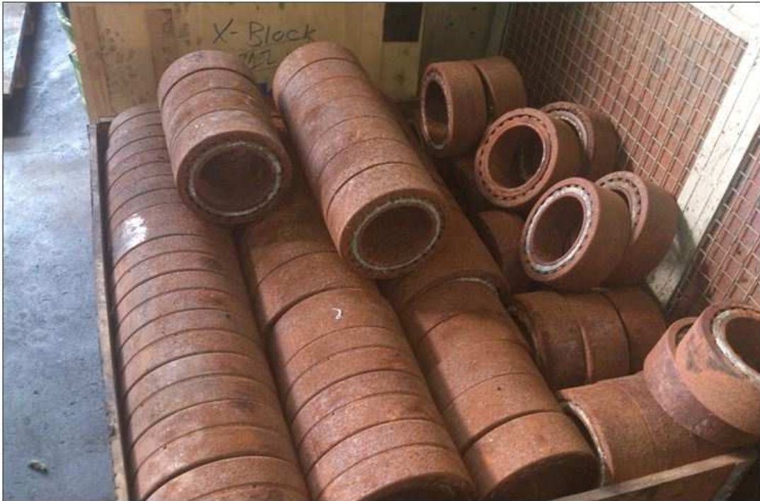
Lote de Rolamentos Oxidados pelo processo de banho em água e sal .
