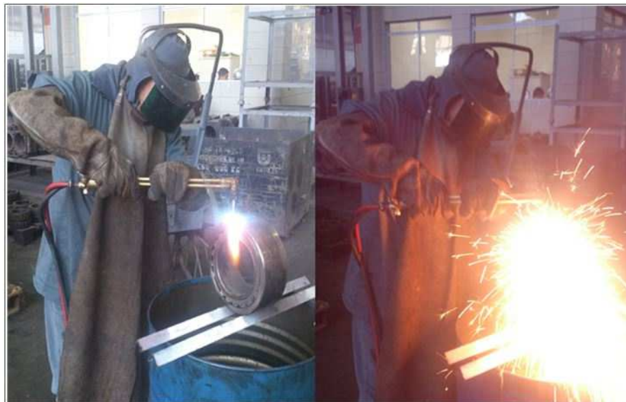
Corte parcial para não reutilização no mercado paralelo Geração de gases tóxicos, eliminação de resíduos sólidos (borra) e químicos (graxa) e aquecimento excessivo
