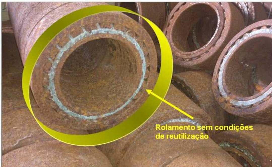
Detalhe da OXIDAÇÃO dos rolamentos pelo processo de Banho em Água e Sal , sem agressão ao Meio Ambiente
