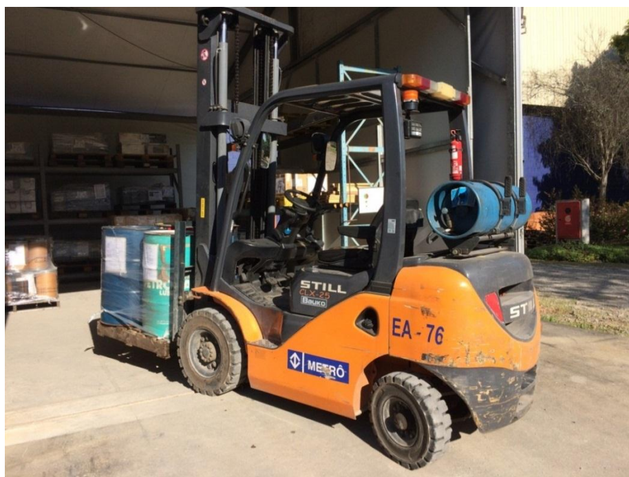
Figura 1 - Empilhadeira a combustão utilizada atualmente
